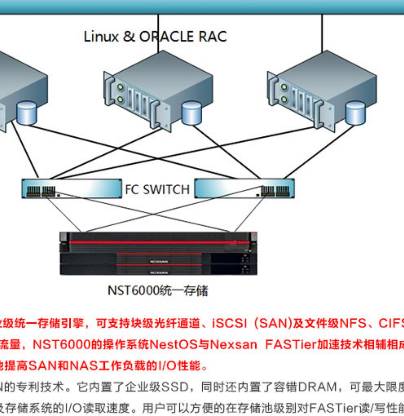
NST6000是一个企业级统一存储引擎，可支持块级光纤通道、iSCSI (SAN)及文件级NFS、CIFS、SMB FTP (NAS) 流量，NST6000的操作系统NestOS与Nexsan FASTier加速技术相辅相成，让客户能够最大限度地提高SAN和NAS工作负载的I/O性能。
